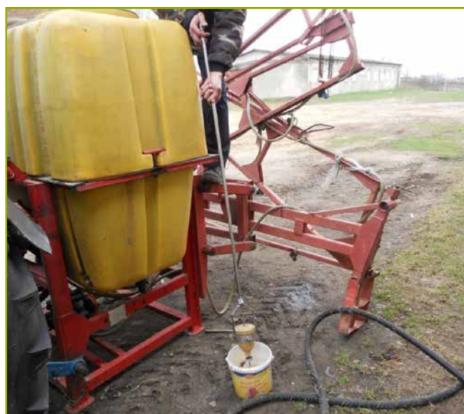
Рисунок 3 – Фрагмент опорожнения стакана пробоотборника от рабочей жидкости
